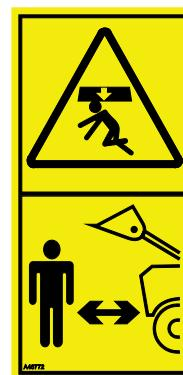
Pidage meeles, et laaduri noolt saab langetada või kallutada, isegi kui mootor on välja lülitatud (muljumisoht). Laadur ei ole möeldud koorma pikaaegseks üleval hoidmiseks. Enne juhiistmelt lahkumist langetage töövahend alati ohutusse asendisse.
